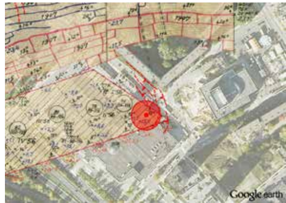
Abb. 5: Oberflächennaher Abbau unter dem Einkaufszentrum 't Loon, mit den 1956 kartierten Erdstufen, dem Senkungsbereich (September 2011) und dem Tagesbruch von Dezember 2011.
